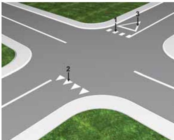
Слика 35. Испрекидана линија заустављања
